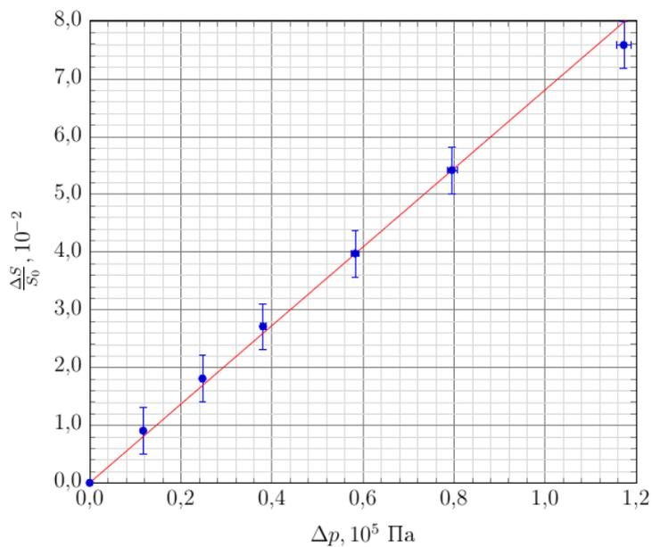
График зависимости относительного изменения площади поперечного сечения трубки от избыточного давления в ней.
